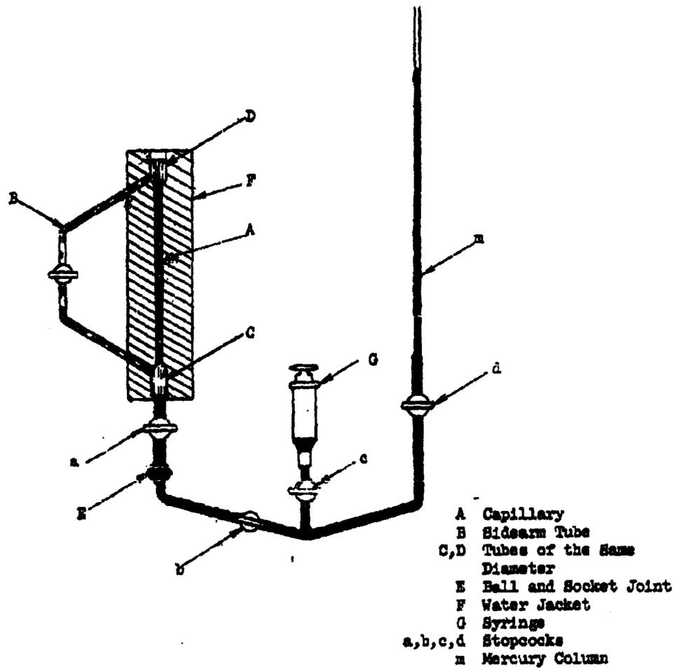
FIGURE 5.2.3 CAPILLARY VISCOMETER
